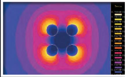
Répartition du flux magnétique dégagé pour 4 câbles cuivre de 300 mm<sup>2</sup> de la même phase.
